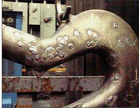
Hook Casting 134 kg (295#) Low-Alloy Steel
